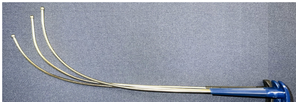
图 2: 一次性管芯与两根可重复使用管芯的对比，显示不同程度的弯曲形变。
