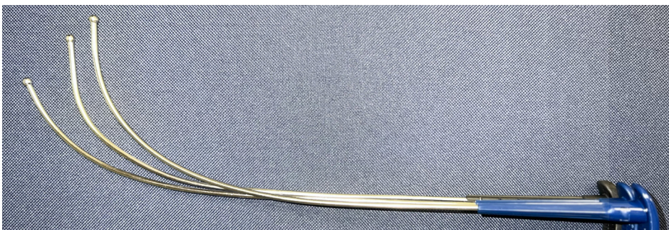
그림 2: 곡률 변형의 다양한 정도를 보여주는 일회용 탐침과 2개의 재사용 가능 탐침의 비교.
