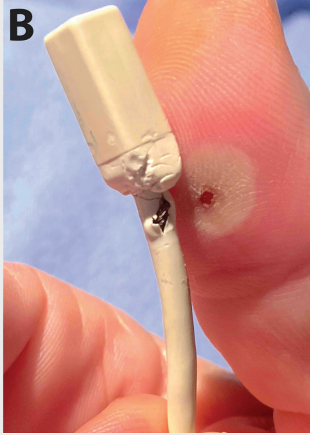
الشكل 1: A. إصابة في إبهام مريض وساعده بعد ساعتين من إجراء جراحة باستخدام جهاز مراقبة انتقال عصبي عضلي (NMT) به كابل تالف. B. صورة للجهاز التالف من اتجاه التوصيل الصحيح تُظهر وجود سلك مكشوف في موضع إصابة المريض.
