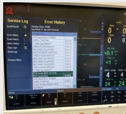
图3：显示 “DU to PSC Comm Error” (DU 至 PSC 通信错误) 和 “POWER CNTRL COM FAIL” (电源 CNTRL COM 故障) 的错误日志
