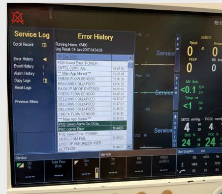
Figura 3: Registro de error que muestra “DU to PSC Comm Error” y “POWER CNTRL COM FAIL”
