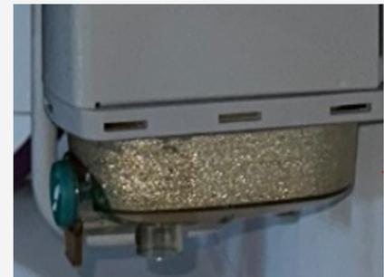
Figure 4 : Condensation dans le réservoir.
