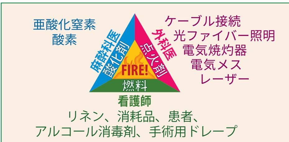
図1: 火災の発生に必要な3つの要素、すなわち酸素、燃料、発火源を示している。
