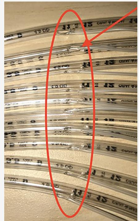
图 2：此图中展示了多根儿科用气管导管残次品的近指示囊插入处存在的小孔。小孔直径各有不同。
